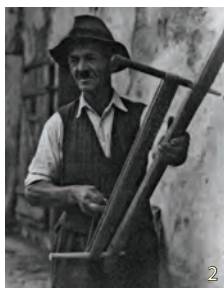
1. Dřevěný nůž vytváří prošlup při tkaní popruhů. 2. Napínání osnovy na neúplný rám.
