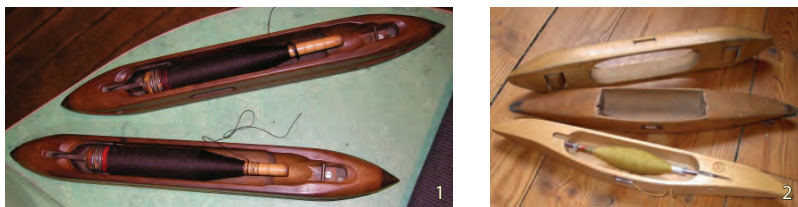
1. Tkalcovský člunek pro mechanické tkaní. 2. Člunek pro ruční tkaní.
