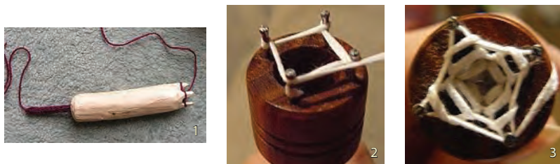
1. Primitivní nástroj pro vytváření dutinky. 2. Počáteční fáze při „pletení“ na cívce. 3. Princip „pletení“ dutinky na cívce.
