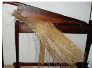
1. Typy mědlíc. 2. Postup při lámání lnu na lamačce.
