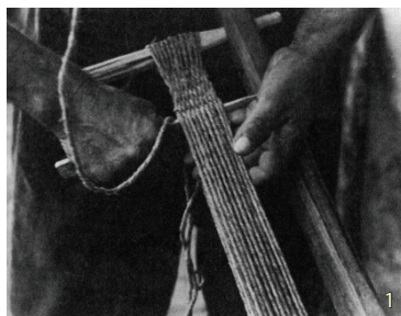
1. Dřevěný nůž vytváří prošlup při tkaní popruhů. 2. Napínání osnovy na neúplný rám.
